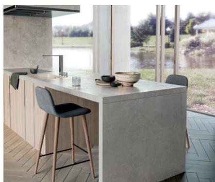
Wir verarbeiten auch hochwertige Küchenarbeitsplatten aus Dekton mit hervorragenden technischen Eigenschaften. Dekton ist die neue ultrakompakte Oberfläche und ein Material aus Keramik, Glas und Quarz. Dieses Material ist eine äußerst vielseitige und hochbeständige Option, da es nicht porös ist. Dekton bietet unbegrenzte Gestaltungsmöglichkeiten und überzeugt neben dem Design durch die einfache Montage.
